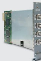
CRC-Modul mit BNC-Anschlüssen
