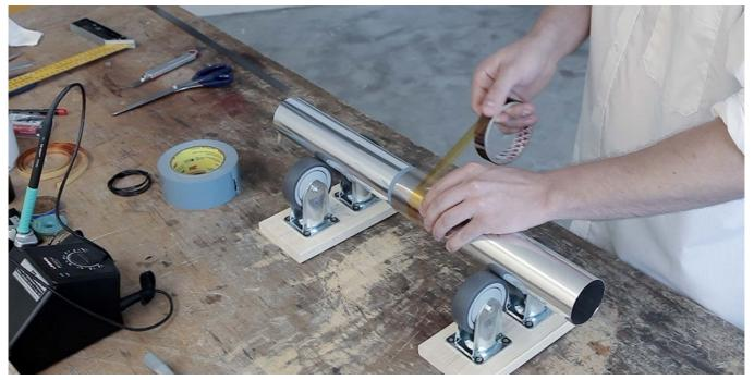
Fig. 33: Apply Kapton tape
