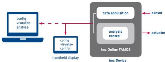
Zeitsynchron und deterministisch können von imc Online FAMOS kanalübergreifende mathematische Berechnungen durchgeführt werden, Statistiken angelegt, Vergleiche getätigt oder anspruchsvolle Steuer- und Regleralgorithmen berechnet und ausgeführt werden. Somit spart imc Online FAMOS Zeit und Geld, denn eine nachträgliche Auswertung entfällt ganz oder wird erheblich verkürzt.
